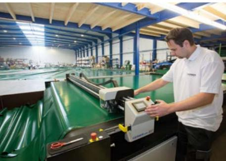
Computergesteuertes Zuschneiden der Membranen
