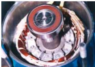
Stator (elektrische Wicklung) und Rotor bei GTWS
