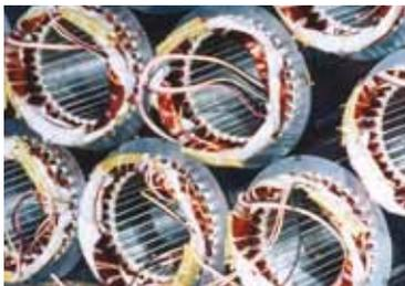
Elektrische Wicklung (Statorblechpaket mit eingebrachter Drehstromwicklung)
