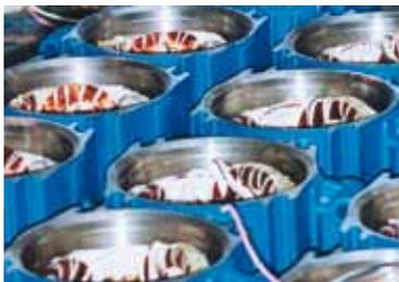
Elektrische Wicklung (Stator) eingepresst in Motorgehäuse
