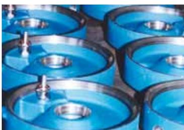
Lagerflansch mit eingebauter Dichtungssonde
