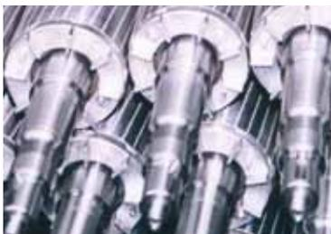
Welle mit aufgepresstem Rotor
