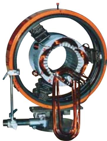
Einlegen der Drehstromwicklung in das Statorblechpaket
