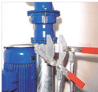
Umstellhebel für Rühren und Fördern
