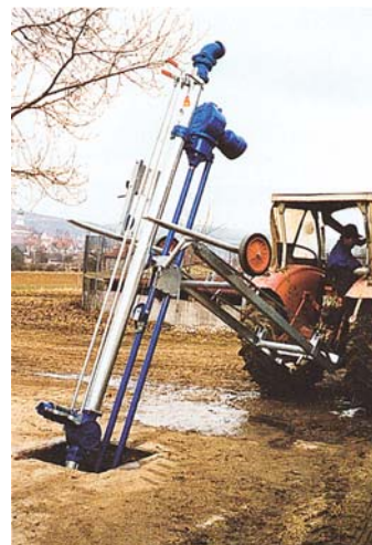
V-Pumpe mit Aushubrahmen und Seilwinde
